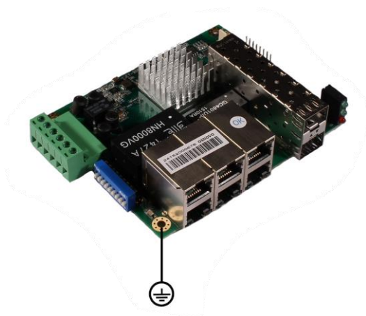
Рис.6 Заземление коммутатора SW-50602/I-P
