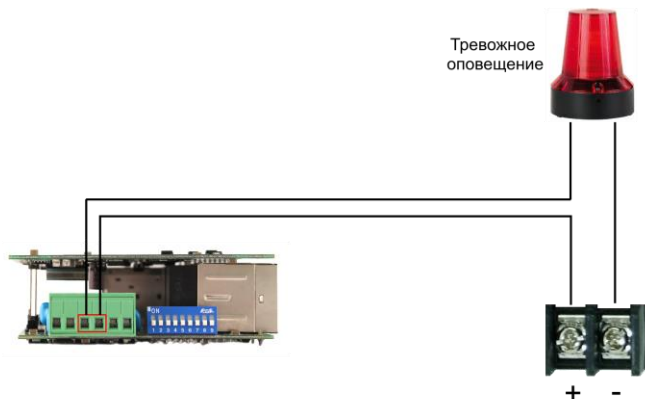
Рис.6 Схема подключения системы оповещения к коммутатору на примере модели SW-60602/ILC-P.
