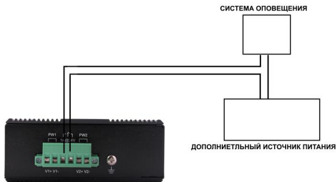
Рис.8 Схема подключения системы оповещения к коммутатору SW-8052/IC
