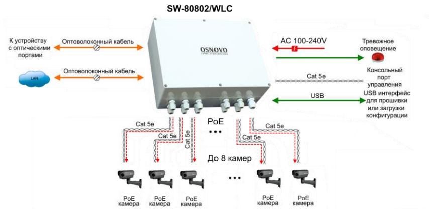
Рис.6 Типовая схема подключения уличного коммутатора SW-80802/WLC
