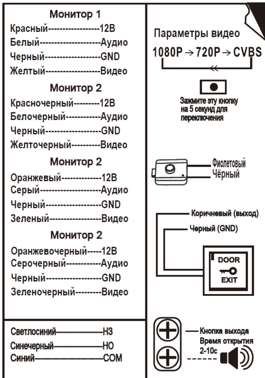
Рисунок 2. Соответствие цветов и назначения проводов вызывной панели.
