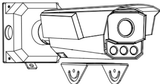
Рисунок 2-19 Установка верхней части установочной площадки
