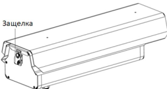
Рисунок 2-1 Корпус I типа
