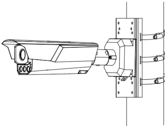
Рисунок 2-25 Установка камеры
