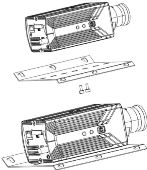
Рисунок 2-3 Установка камеры на подставку
