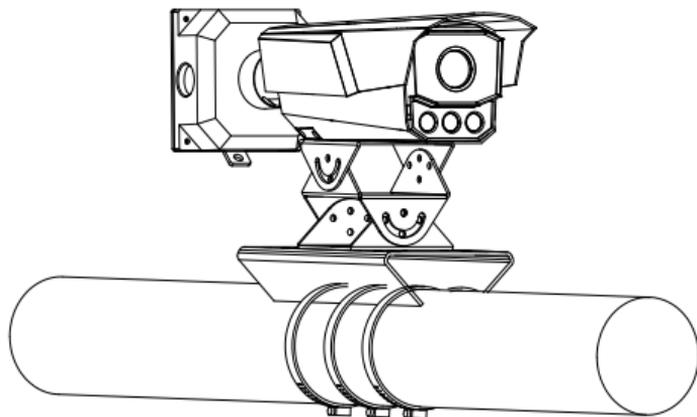
Рисунок 2-20 Соединение обеих частей установочной площадки
