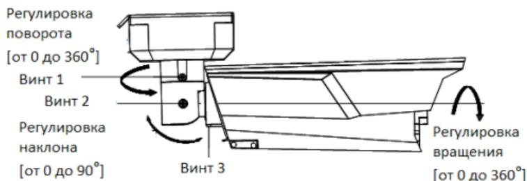
Рисунок 2-16 3-х осевая регулировка
