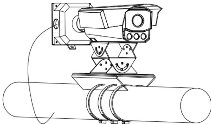
Рисунок 2-22 Крепление установочной пластины
