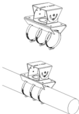
Рисунок 2-5 Установка кронштейна на поперечный брус
