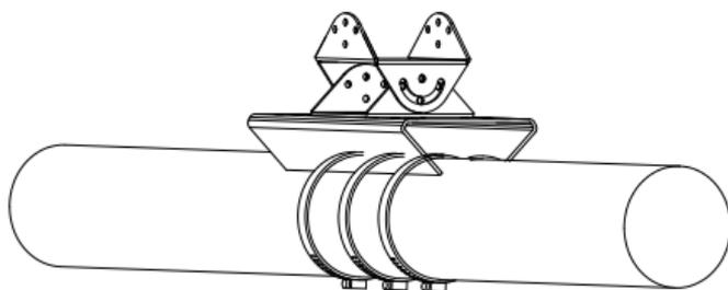
Рисунок 2-18 Крепление нижней части установочной площадки
