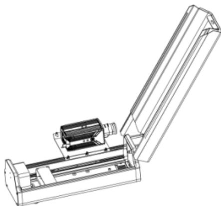
Рисунок 2-4 Установка подставки с камерой в корпус
