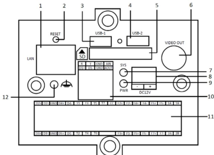
Рисунок 1-4 Внешний вид задней панели камеры II типа
