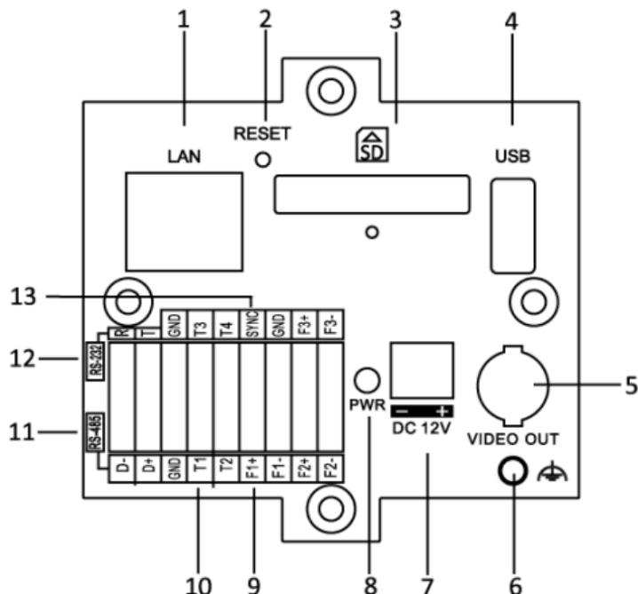
Рисунок 1-3 Внешний вид задней панели камеры I типа
