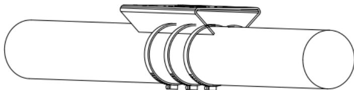
Рисунок 2-17 Установка кронштейна на поперечный брус
