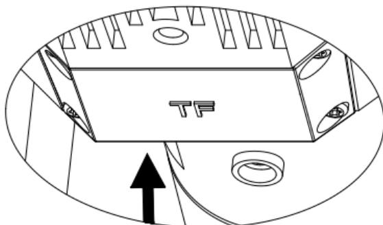
Рисунок 2-13 Крепление крышки с помощью шурупов
