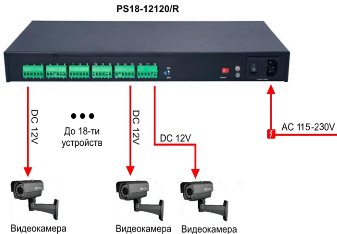
Рис.3 Типовая схема подключения блоков питания PS18-12120/R, PS18-12240/R на примере блока питания PS18-12120/R
