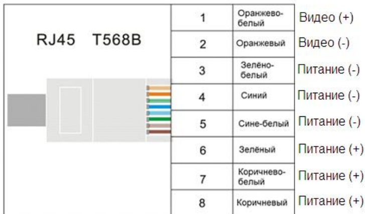
Рис.5 Распиновка разъемов RJ45
