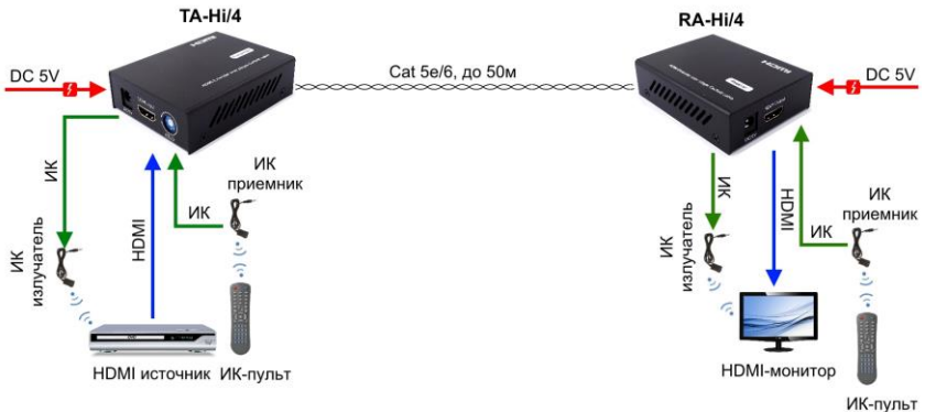
Рис.8 Схема подключения TA-Hi/4 + RA-Hi/4
