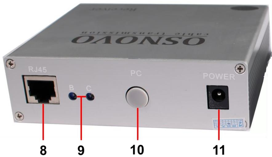
Рис. 6 RA-VKM/3(ver.2), RA-VKM/5, RA-VKM/7, разъемы и индикаторы передней и задней панелей приемников
